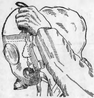
一兩手分握面罩上端之 左右四條繫帶 二下顎套入下顎托中
