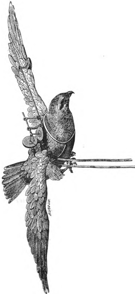
Фиг. 99. — Сарычъ, летающій съ аппаратомъ, который записываетъ движенія верхушки его крыла.
