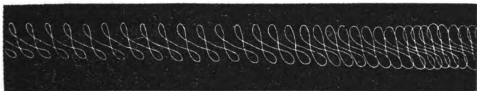
Фиг. 76.—Чертежъ Уэтстоновской пластинки, настроенной на октаву, т. е. дѣляющей два поперечныхъ колебанія на каждое доленое (рис. заимствованъ у Р. Кёнига).—Замедленіе вращеній цилиндра производитъ сгущеніе кривыхъ къ концу рисунка.
