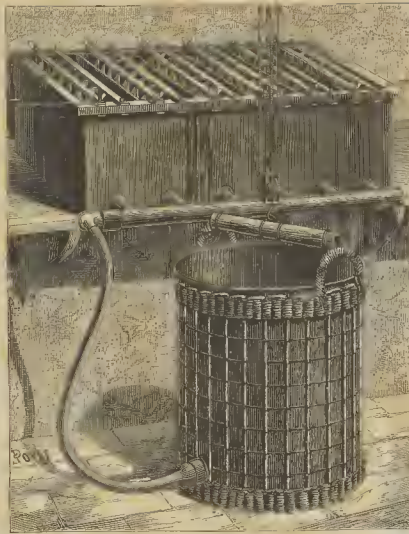
Fig. 1.—BATERÍA DE SEIS ELEMENTOS DE PILA DE BICROMATO DE POTASA
