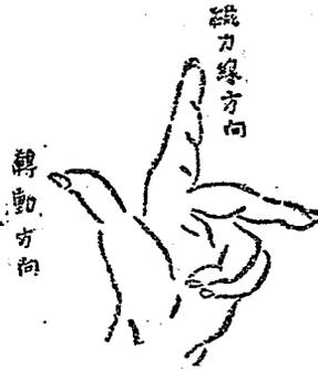
故使導線向下移動。導線中電流如果是由紙面流出，如(B)，結果適相反，使導線向上移動。所以通有電流的導線放置磁場中必發生一種力，使導線移動。移動的方向，可依佛來銘左手定則決定之，見第二二圖。伸出左手的大指，食指和中指，互成直角，中指指電流方向，食指指磁力線方向，則大指所指，即為移動方向。
