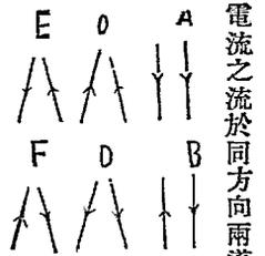
電流之流於同方向兩導線平行時。如圖A則相吸引。其電流之方向流於反對時。如圖B則相斥。遂又電流不限定全並行之地位。而兩個之導線。成爲某角度時。流於此之電流。共流於頂點之方向時。如圖C。或共流於頂點反對之方向時。如圖D。則相吸引。若一方之電流。向頂點之方。他一方之電流。向反對之方向時。如圖E。F。則相衝突。
