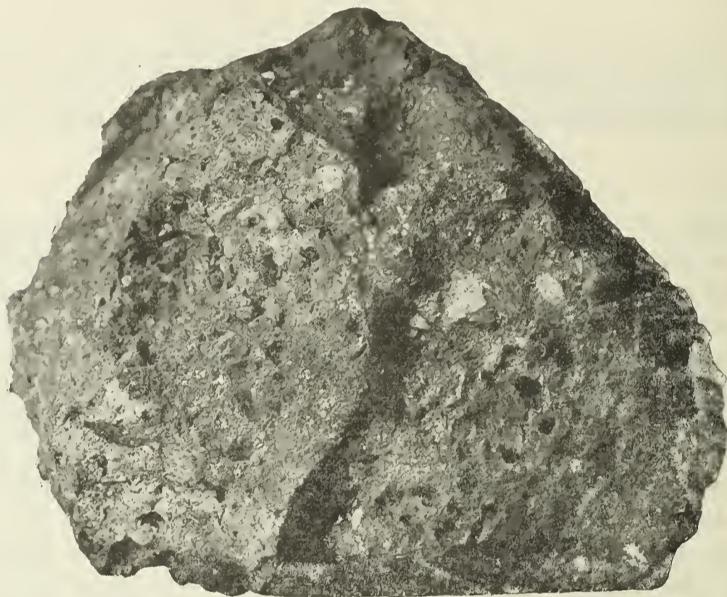
Марганцовая руда изъ Николаевского рудника (къ востоку отъ р. Томаковки), содержащая большое количество кварцевыхъ зеренъ.
