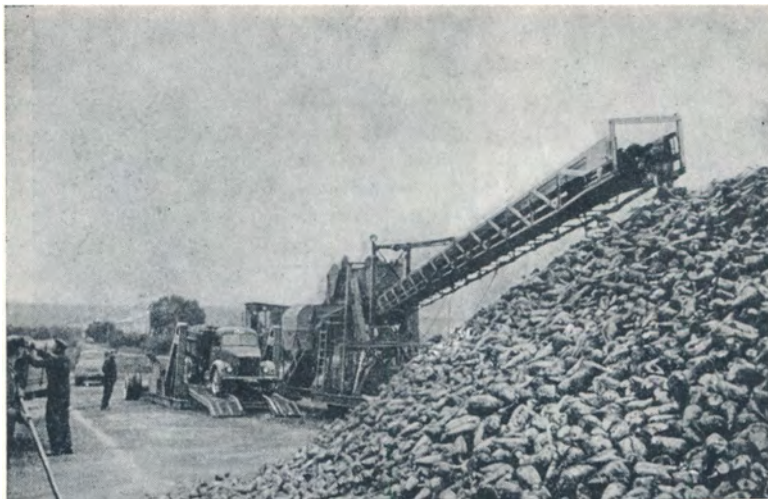
Механічне розвантаження буряків на приймальному пункті цукрового заводу в с. Зарожанах. 1965 р.
