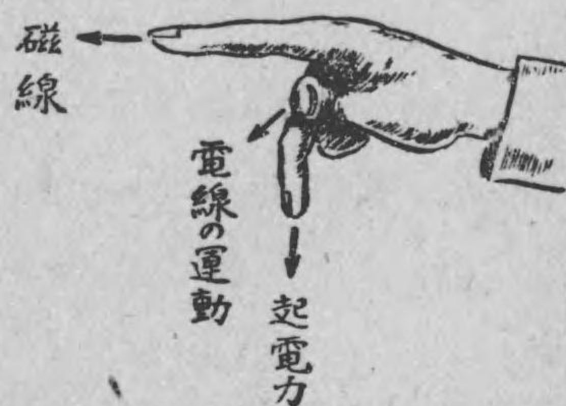
磁線を切つた時の起電力の方向を知る法 (フレーミングの右手三指の規則)
