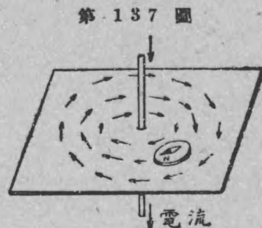
第 137 圖 電流の方向と其の磁線の方向との關係を知る實驗
