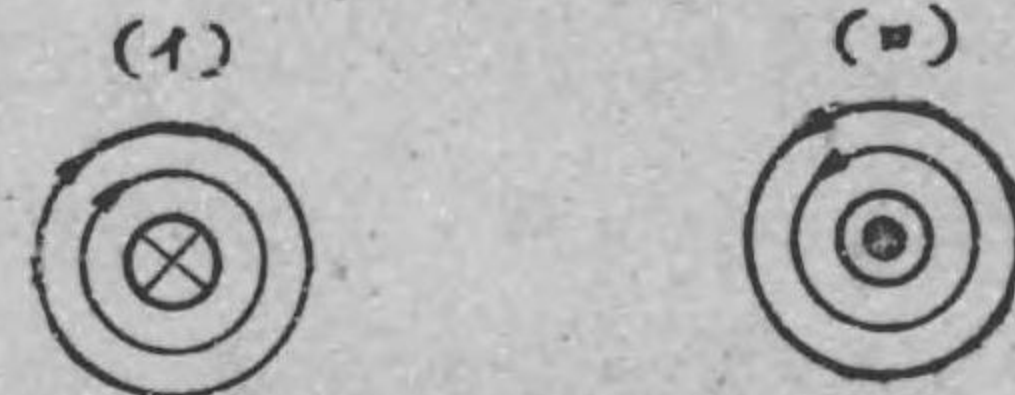
紙面に直角の電流とそれによる磁線との關係
