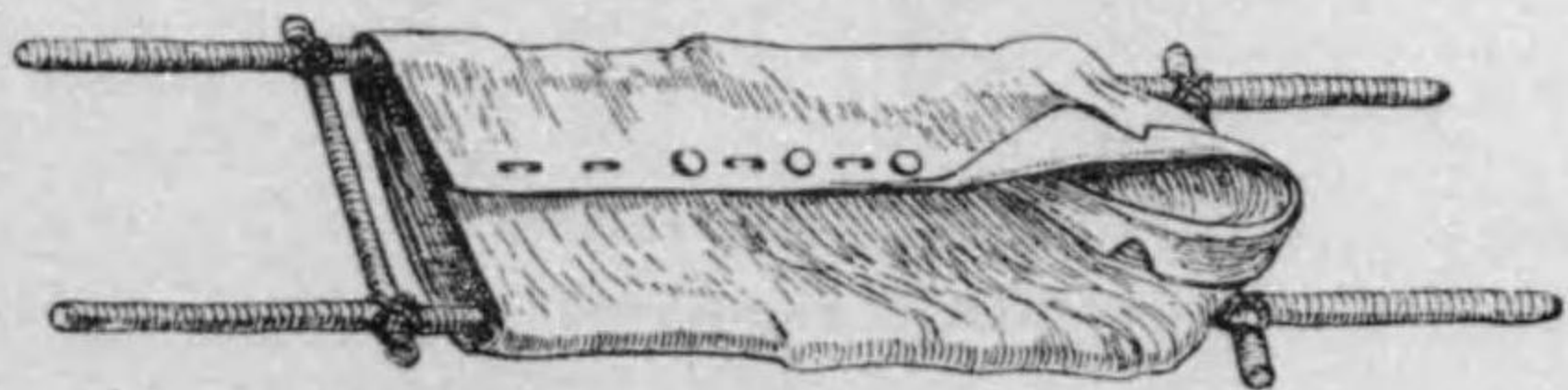
圖 四 十 五 第 ノモルレ終テ立組架擔造急ル作テニト套外ト棒
