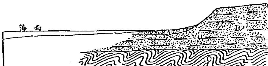
阿拉斯加，娜姆地方之海岸砂金地斷面圖 A為砂礫層及砂金層。
