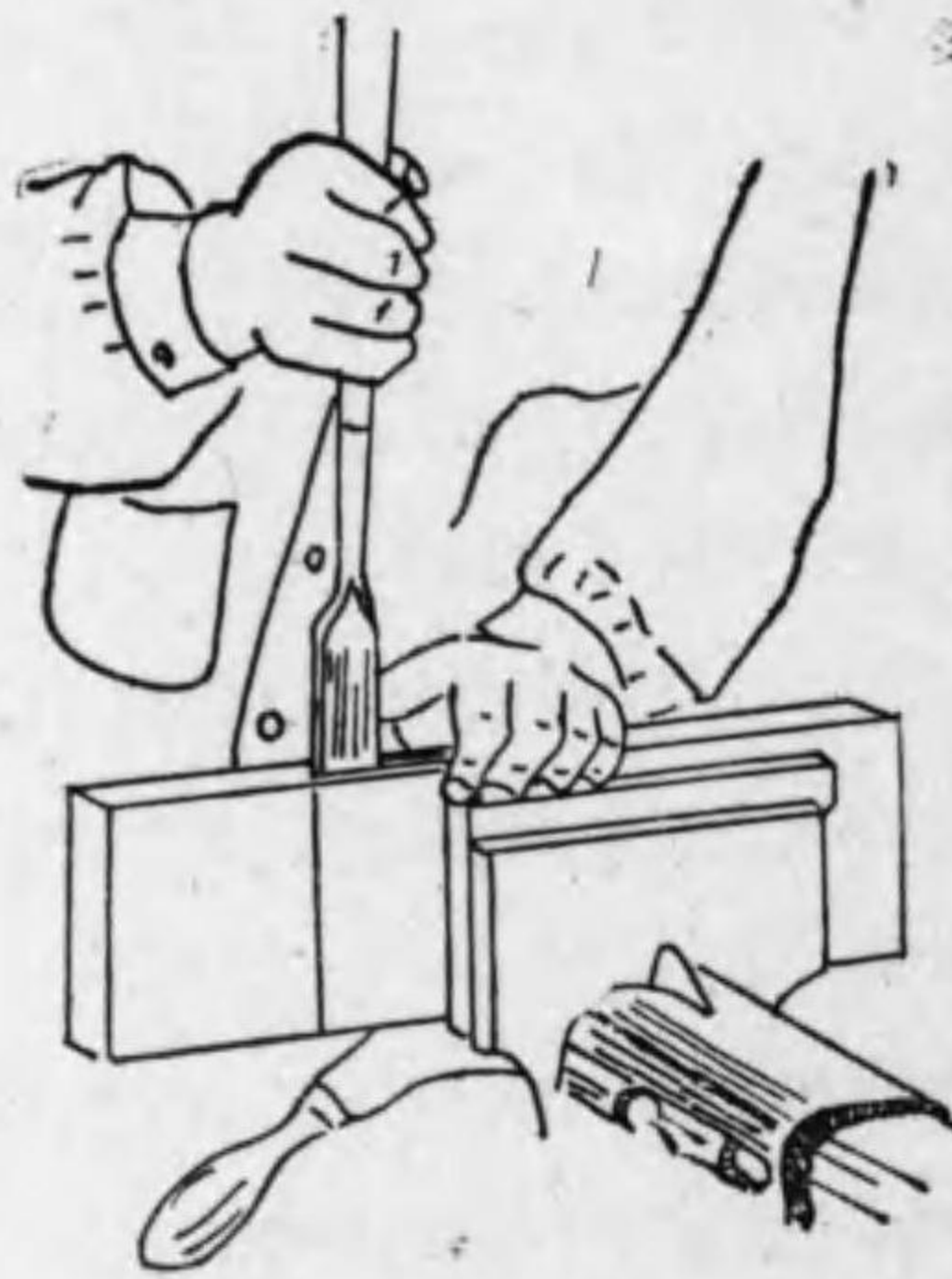
第四八圖 突鑿の使ひ方
