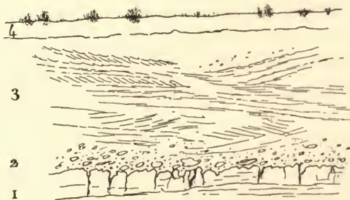
Fig. 17. — Carrière à Hommes. 4, Terre végétale rougeâtre, 0,10; 3, Falun blanchâtre en lits obliques, 4 m.; 2, Sable falunien grossier, graveleux, 0,40; 1, Calcaire lacustre gris, corrodé, perforé par des Lithodomes, sur : 0,20.
