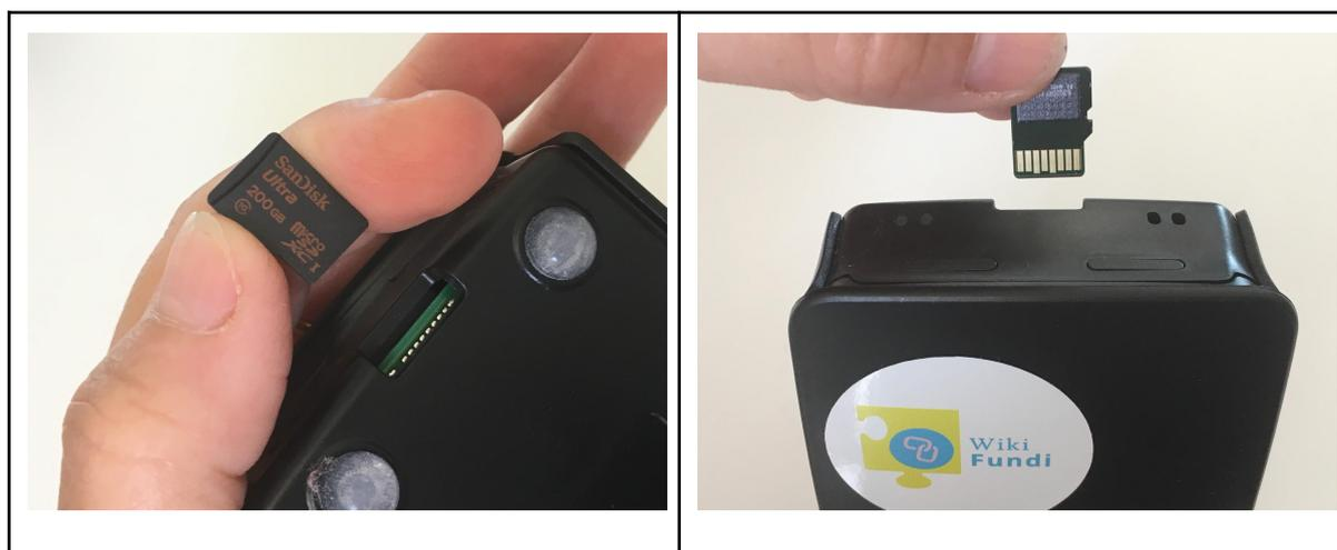
Vue d'un côté et de l'autre. Attention à ne pas insérer la carte dans le mauvais sens...
