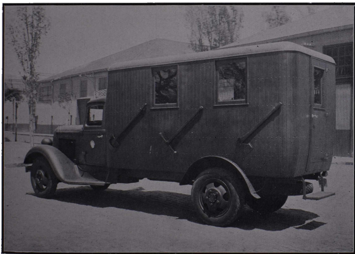
Radiogoniómetro sobre camión. — Carrozado en la D. G. M. E. (Fábrica Militar de Material de Comunicaciones).
