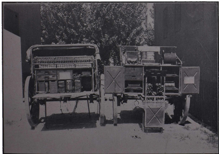
Carro de construcciones telefónicas divisionario. (Vista trasera del avantrén y retrotrén).
