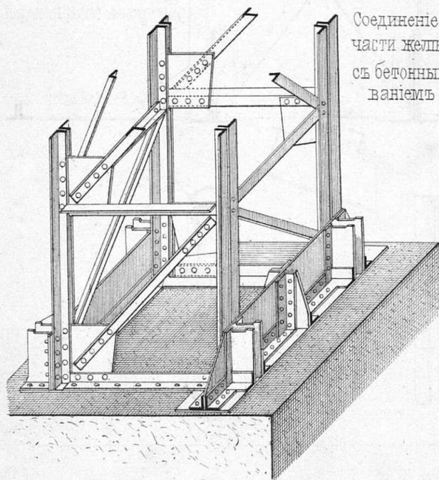
Соединение нижней части желъзъ фермы съ бетоннымъ основаніемъ.
