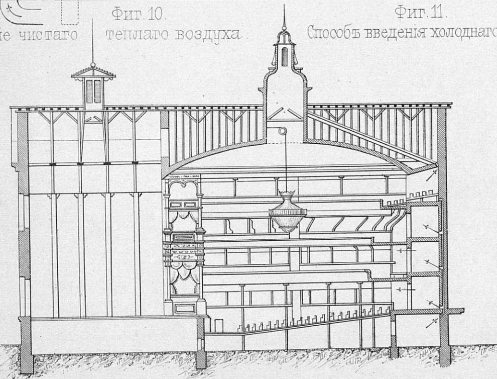
Фиг. 13. Вентиляція и отопленіе по системѣ Д'Арсе.
