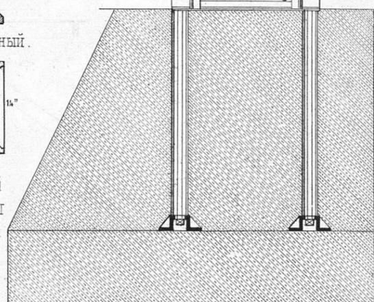
Бетонный фундамент. Fondation en béton.
