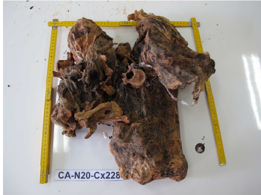
Desintegración del tejido de bolsas contenedoras, caso CA-N20-Cx228
