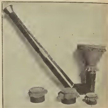
El sencillo é ingenioso aparato llamado eidófono y algunos recipientes, por cuyo medio se registran las vibraciones de la voz.
