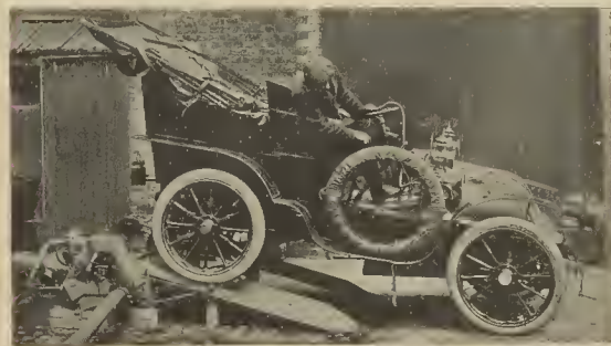
Automóvil retrocediendo por planos inclinados para quedar enganchado á la bomba de incendio
