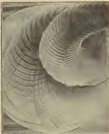
Impresiones de la voz obtenidas poniendo colores á la aguada sobre un cristal
