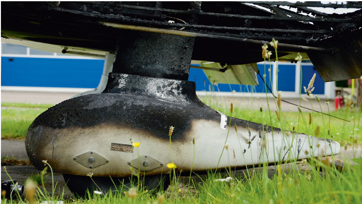
Figuur 8: Zijaanzicht PH-HLR van de linkerwielkap en de stroomlijnkap van het linkerlandingsgestel, beschadigd door de hitte. (Foto: Onderzoeksraad voor Veiligheid)
