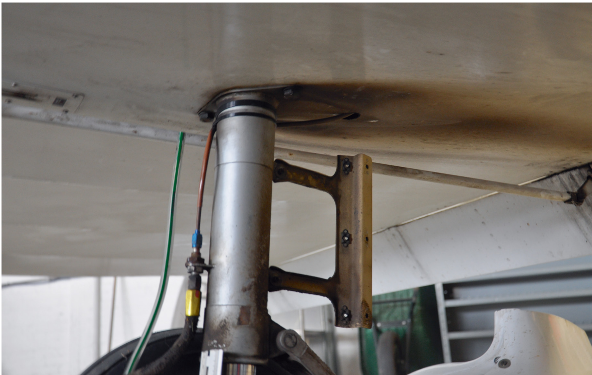
Figuur 11: Zijaanzicht van het rechterlandingsgestel van de PH-HLR. Beide stroomlijncappen zijn verwijderd, waardoor de donkergekleurde veeg op de vleugelbekleding zichtbaar is. (Foto: Onderzoeksraad voor Veiligheid)
