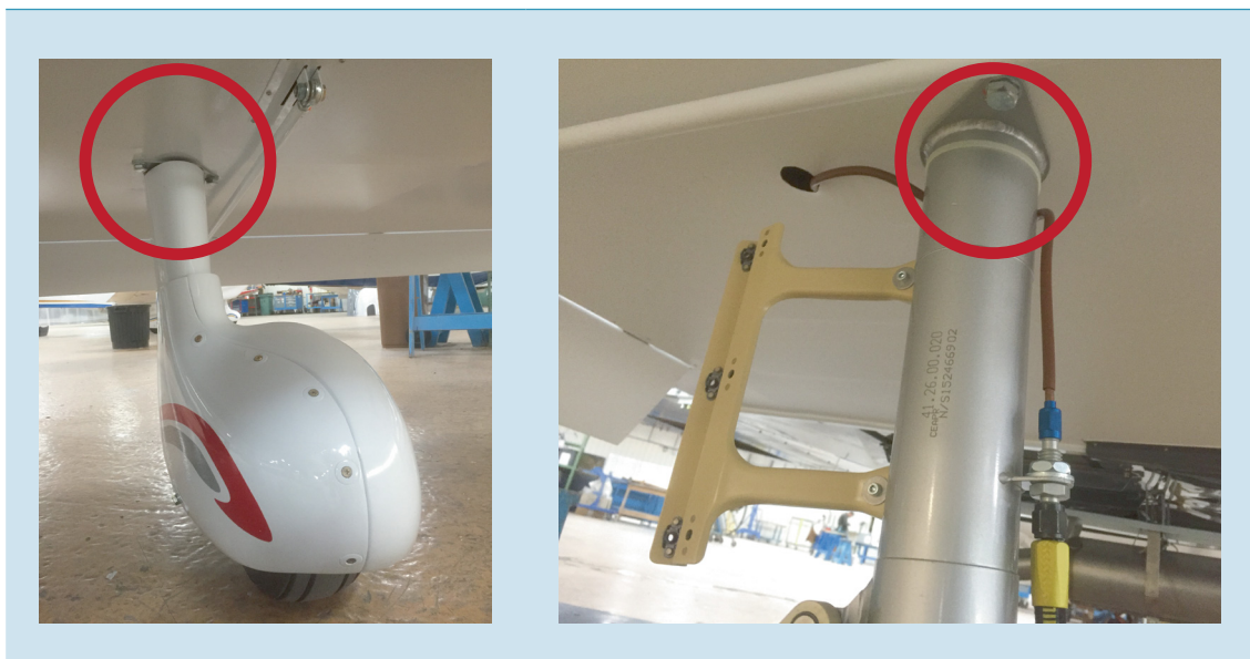
Figuur 15: De vleugel-landingspoot verbinding (rood gemarkeerd), gezien met en zonder stroomlijnkappen tijdens de fabricage. (Foto's: Onderzoeksraad voor Veiligheid)
