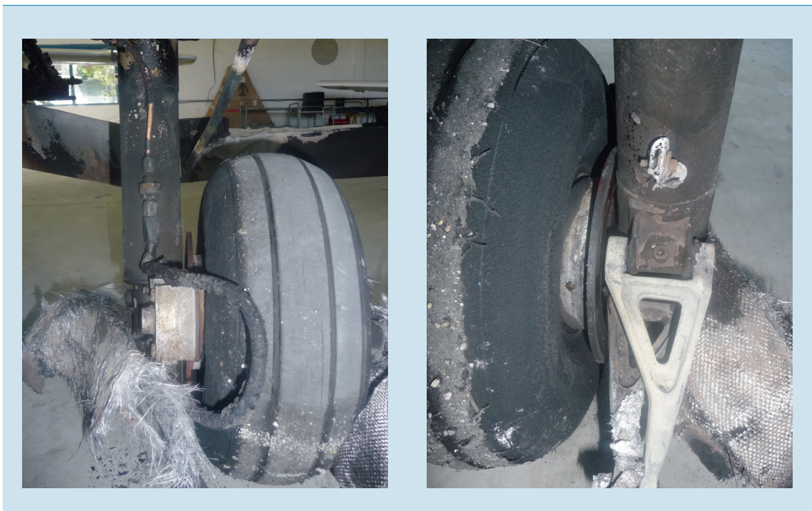
Figuur 7: Het kapotte linkerlandingsgestel en de stroomlijnkop van de PH-SPZ, gezien vanaf de voorzijde (foto links) en vanaf de achterzijde (foto rechts). (Foto's: Onderzoeksraad voor Veiligheid)
