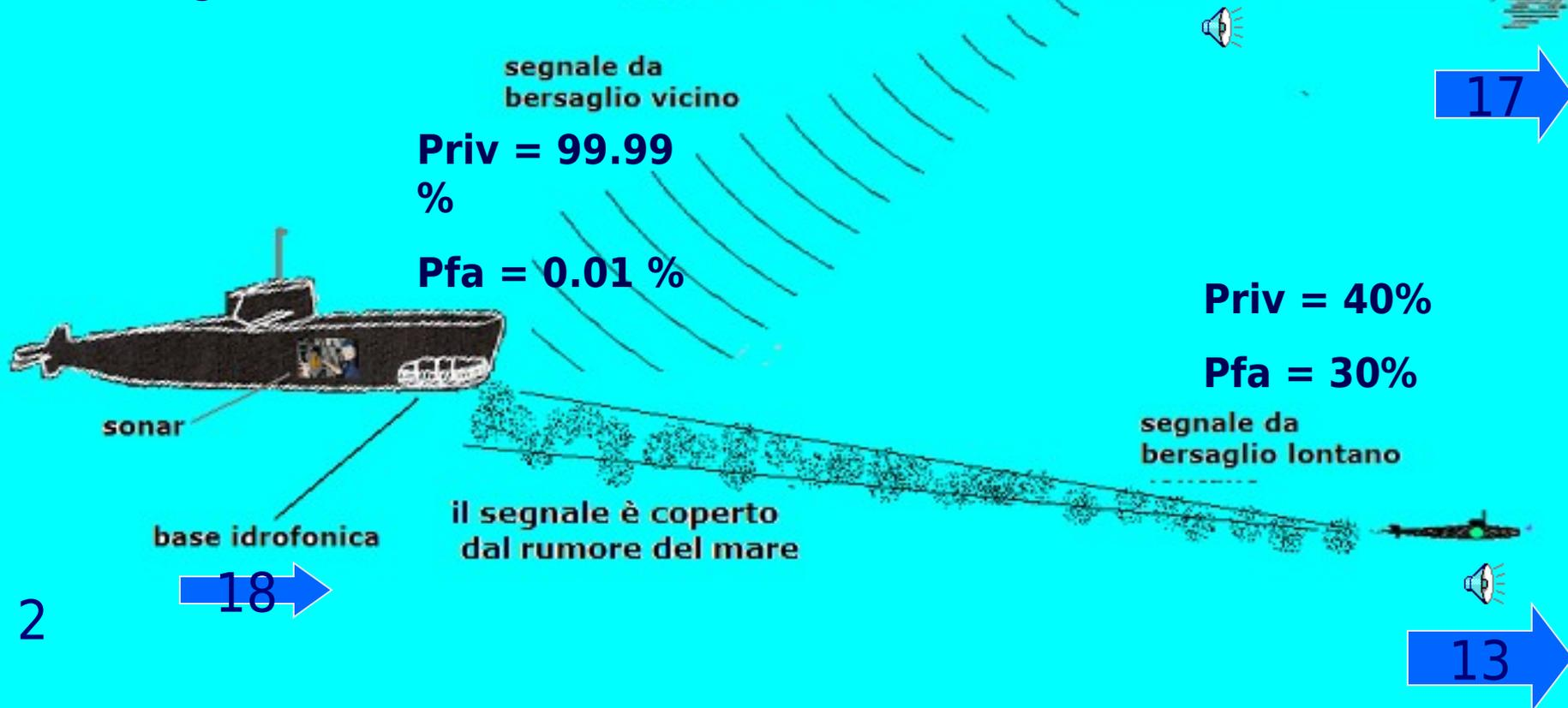
Le “ funzioni di correlazione  $C(\tau)$  ” sono algoritmi sviluppati da macchine (**correlatori**) che, tramite opportuni livelli numerici o di tensione, consentono l'individuazione di segnali elettrici specifici, **rimessi in coerenza**, mascherati da disturbi a carattere casuale.
