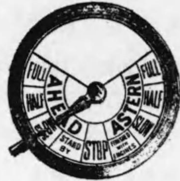
傳 令 機 (機 關 室)
