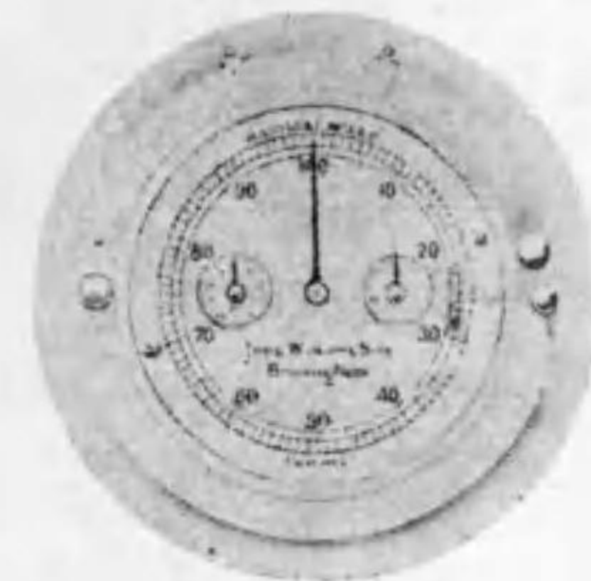
標示牌(船橋ニ取附ケ電流ニ依リ航走距離ヲ表示ス)
