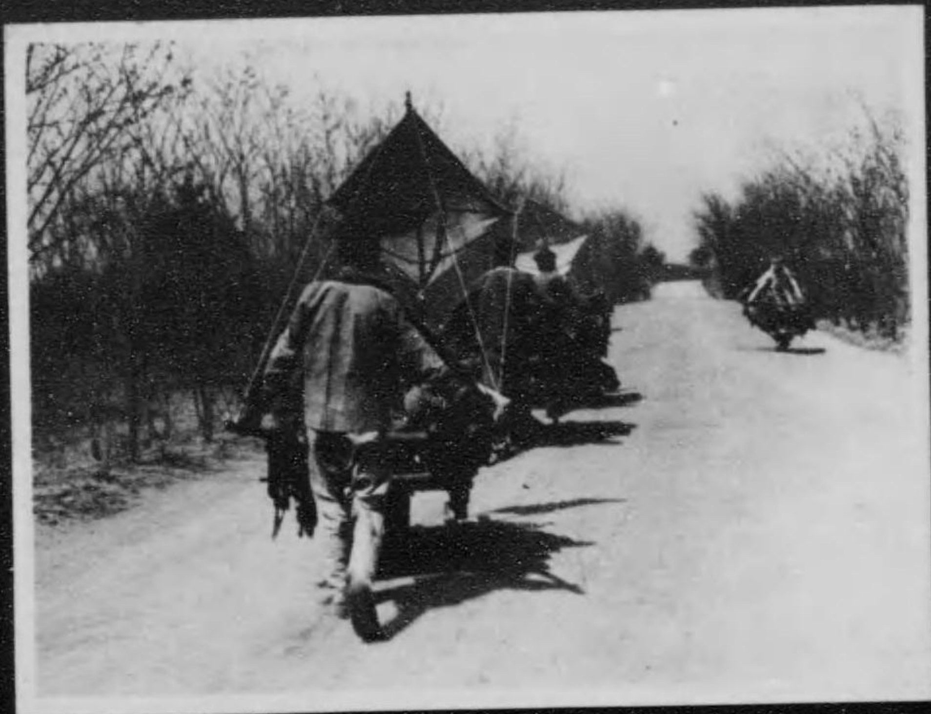
● 帆かけ一輪車 (山東省) 支那人は自然力の利用に巧みなものはないといふことは毎度感服せられるが一輪車に帆をつけて勞力の節約を計つて居るなどは天下の一品だ。而して支那の原始的慣習からいへば車は引くものでなくて押すものである。彼等は帆を使ふにも繩を用ゆるのも日本人の習慣から見れば皆逆な力を用ゆるのも怪である。 (印畫の複製を感懐す)
