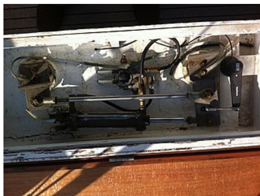
Système de commande de l'angle de barre des trois safrans de la goélette. Le petit safran central, situé derrière l'hélice, sert à faire pivoter le navire lorsqu'il n'a pas d'erre. Les deux safrans latéraux commandent la rotation lorsque le navire se déplace.
