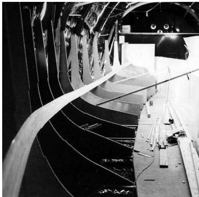
Pose des lattes de moulage sur les gabarits.
