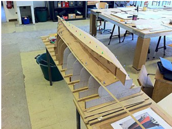
Placement et collage des œuvres vives.
