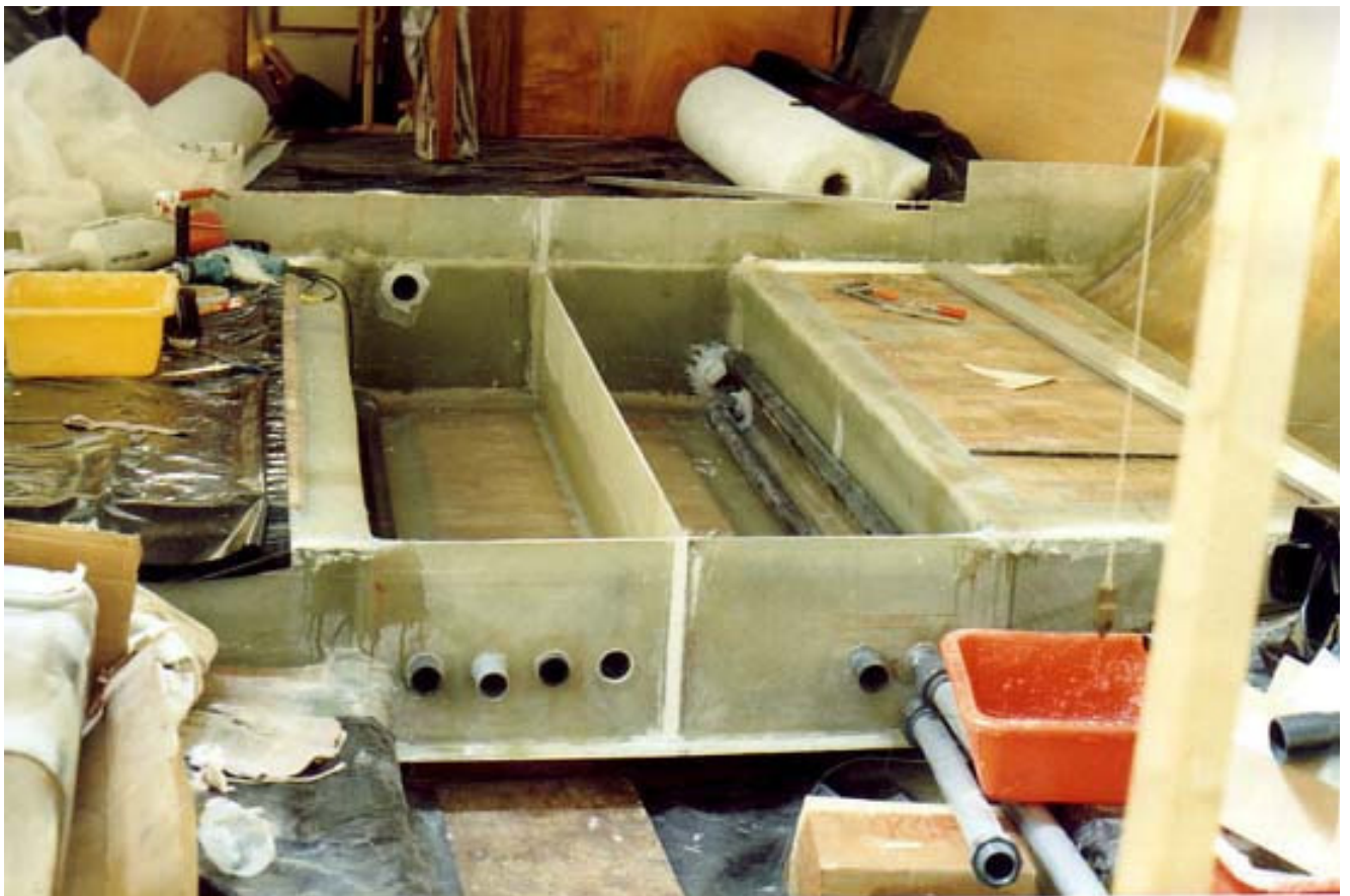
Vue du ballast central avec la pose des canalisations de remplissage et de vidange.
