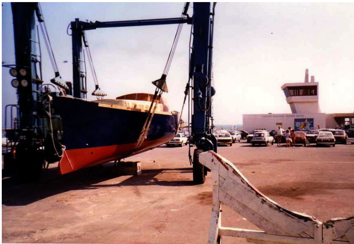
Levage pour la mise à flot
