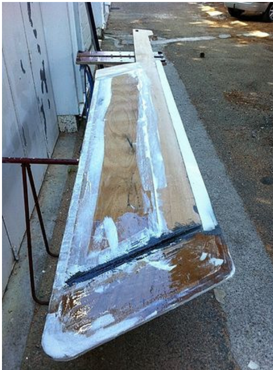
7. Affinage des bords et masticage
