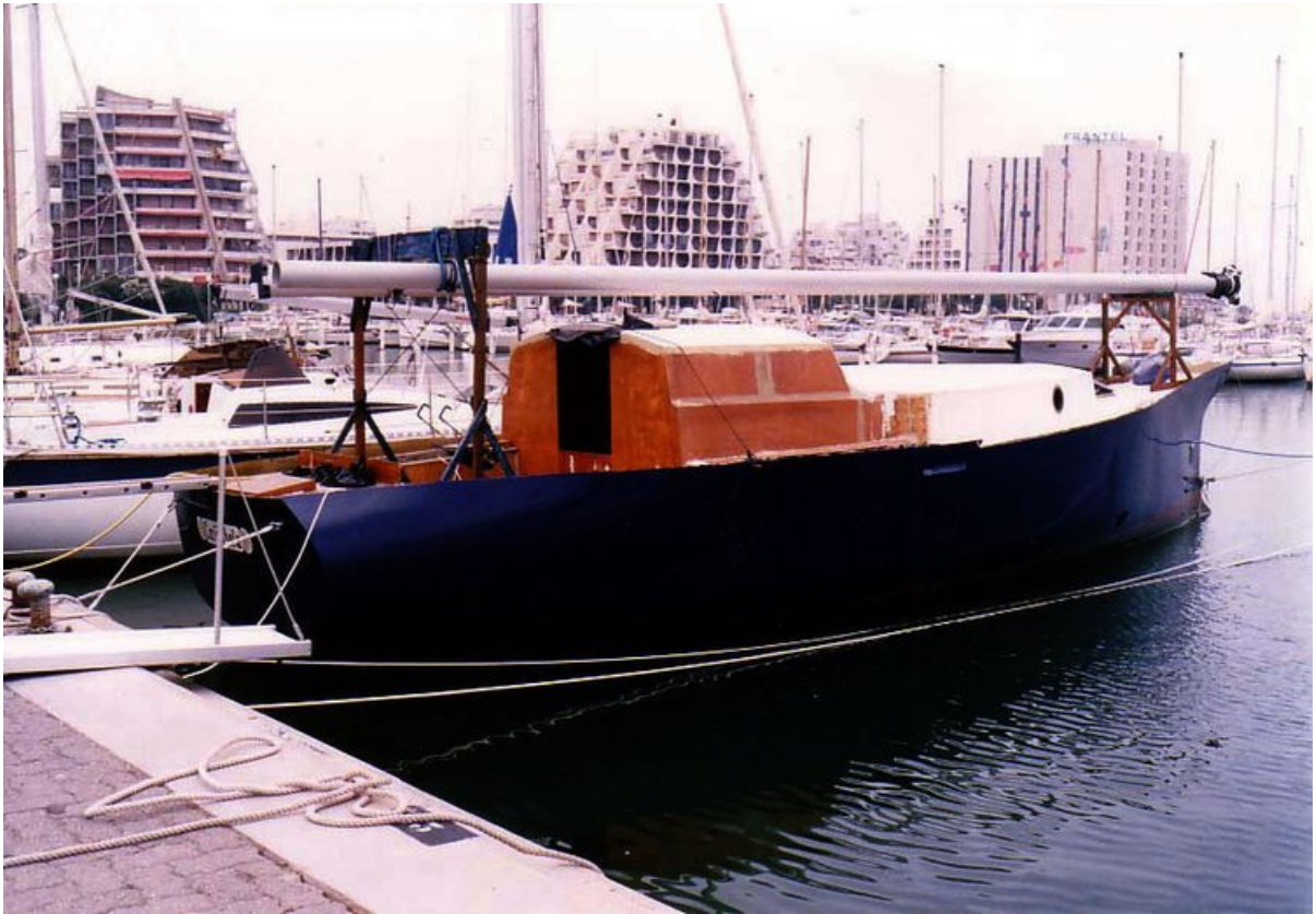
Pose des mâts sur le pont
