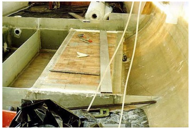
Carré: ballast latéral tribord sous la flottaison.
