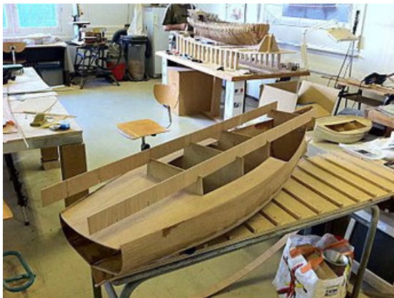
Positionnement des cloisons
