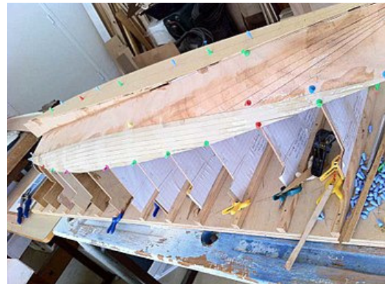
Découpe des baguettes pour le collage des œuvres mortes.
