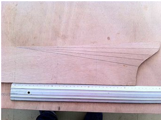
Vue des incisions intérieures pour le cintrage de l'étrave.
