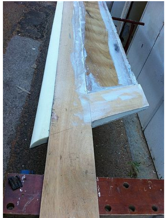
7. Mise en forme du bord d'attaque
