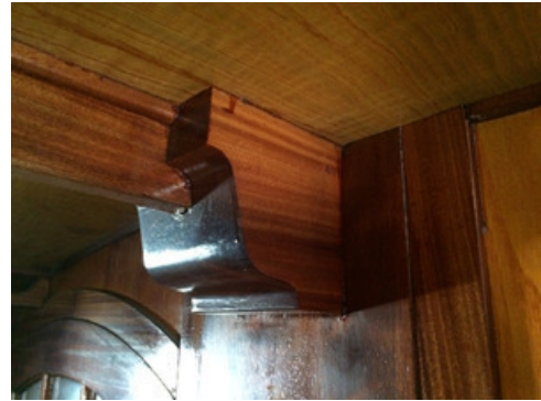
On voit ici le chapeau qui recouvre l'épontille de misaine afin répartir la charge
