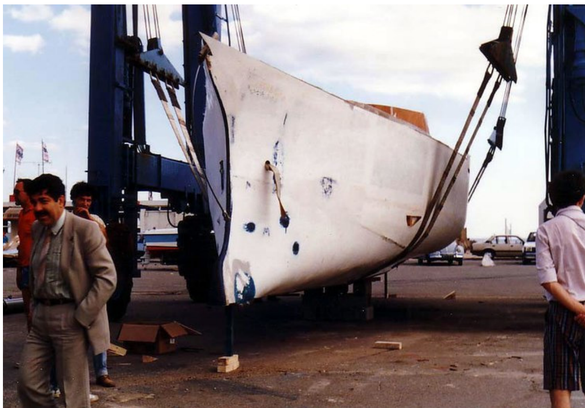
Pose sur poutres bois 300x300
