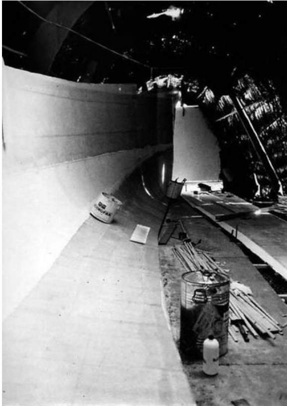
Stratification du bouchain après la pose des plaques de bordé et de carène.
