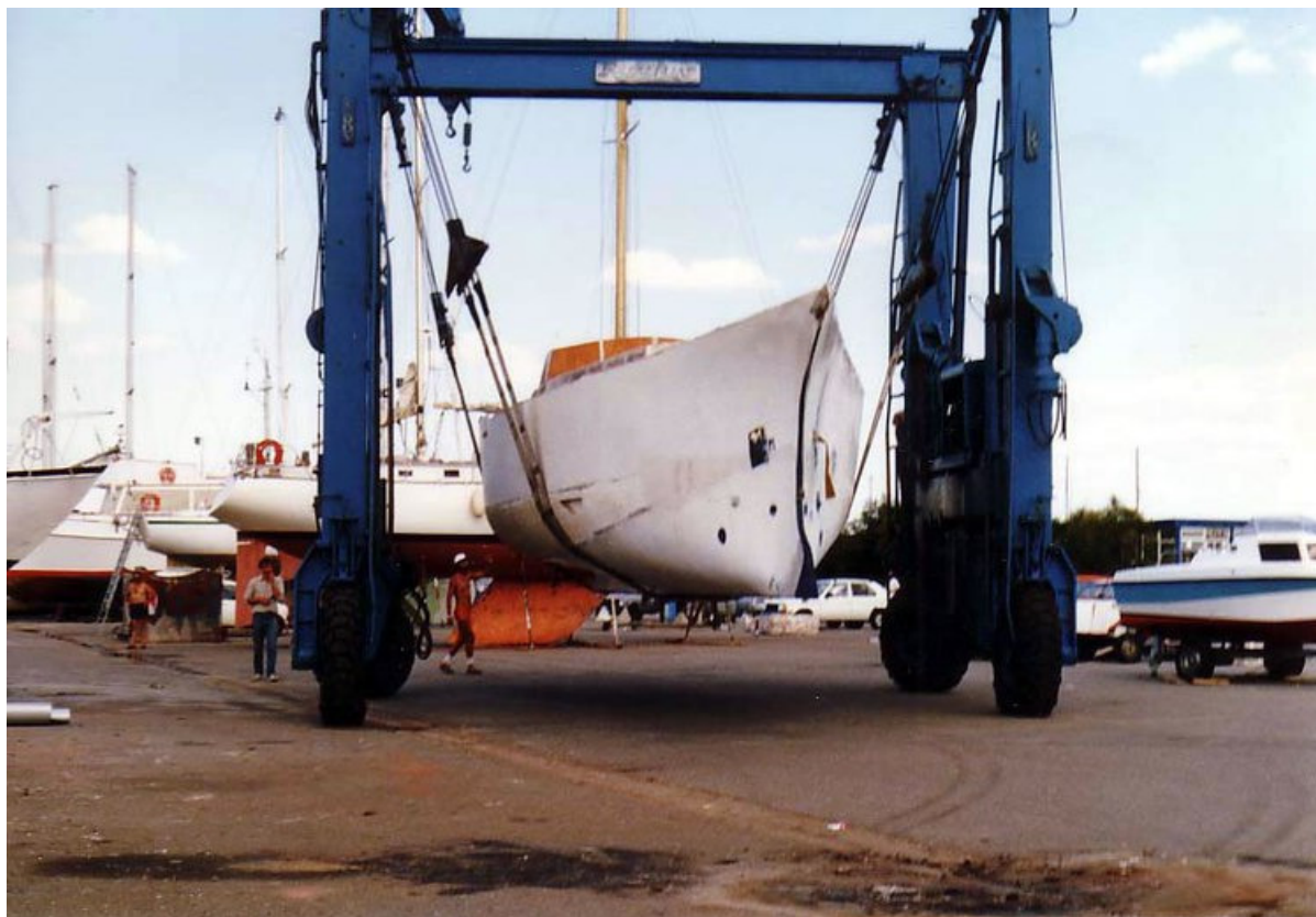
Levage et transport sur sangles
