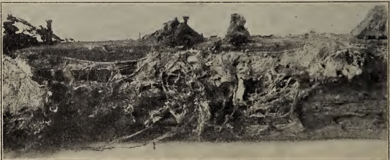
Fig. 3. Stück eines der Eichenlager mit ansitzenden Merulius -Häuten, oben Reste und Nägel des zerstörten Blindbodens auf dem unveränderten Eichenholz, unten partielle „Trockenfäule“ (s. Text).
