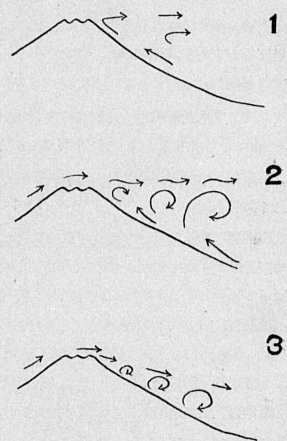
第1圖 風速變化に依る風下氣流の形
