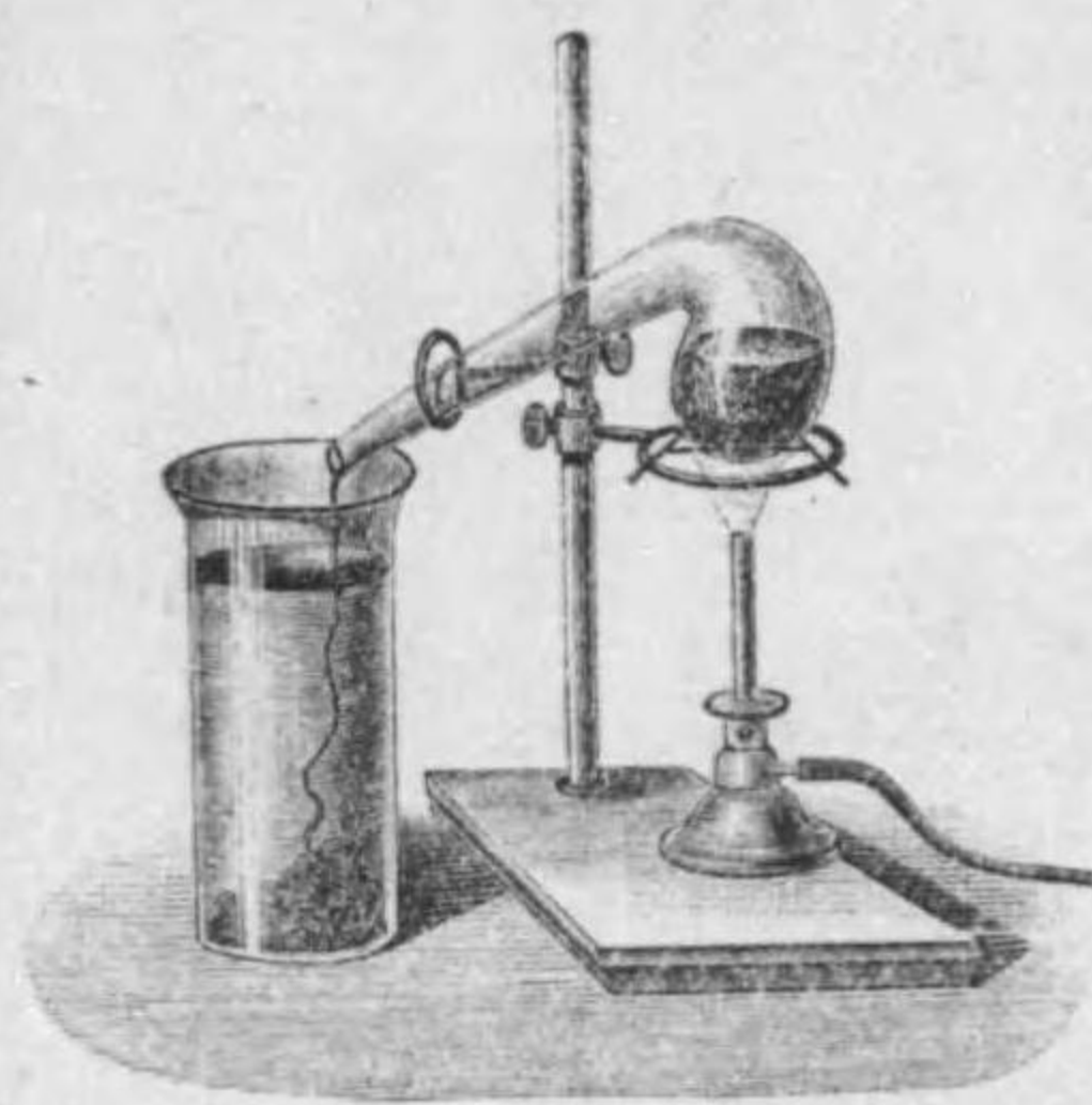
第四五圖 ゴム狀硫黃の製法
