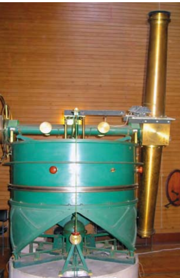
▼ Abb. 6: Das von der Firma Repsold 1863 gebaute Durchgangsinstrument mit einer Brennweite von 2,31 Metern wurde für Messungen im Ersten Vertikal verwendet und diente im Rahmen des Internationalen Breitendienstes zur Beobachtung von Polhöhenchwankungen.
