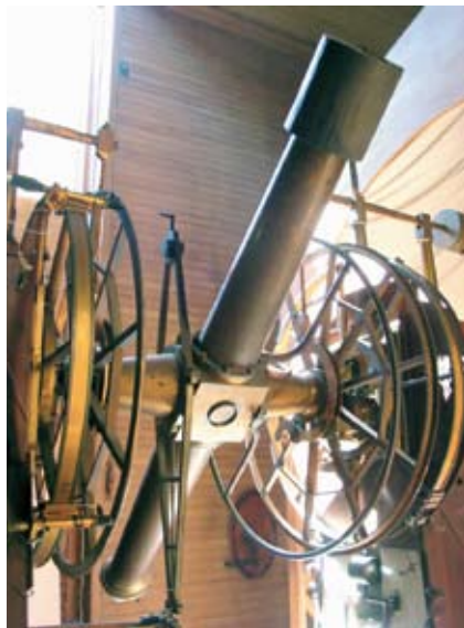
▲ Abb. 3: Die Optik des 14-Zoll-Refraktors stammt von der Münchner Firma Merz, die Montierung erstellte die Hamburger Firma Repsold in den Jahren 1858 bis 1865. Den Okularkopf des Refraktors mit dem Positionsmikrometer stattete die Firma Repsold mit zwei Handscheiben aus (links im Bild). Mit ihnen ließ sich die Rektaszensionsachse der Fernrohrmontierung direkt vom Okular aus feineinstellen und festklemmen.
