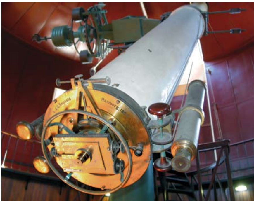
▲ Abb. 3: Die Optik des 14-Zoll-Refraktors stammt von der Münchner Firma Merz, die Montierung erstellte die Hamburger Firma Repsold in den Jahren 1858 bis 1865. Den Okularkopf des Refraktors mit dem Positionsmikrometer stattete die Firma Repsold mit zwei Handscheiben aus (links im Bild). Mit ihnen ließ sich die Rektaszensionsachse der Fernrohrmontierung direkt vom Okular aus feineinstellen und festklemmen.
