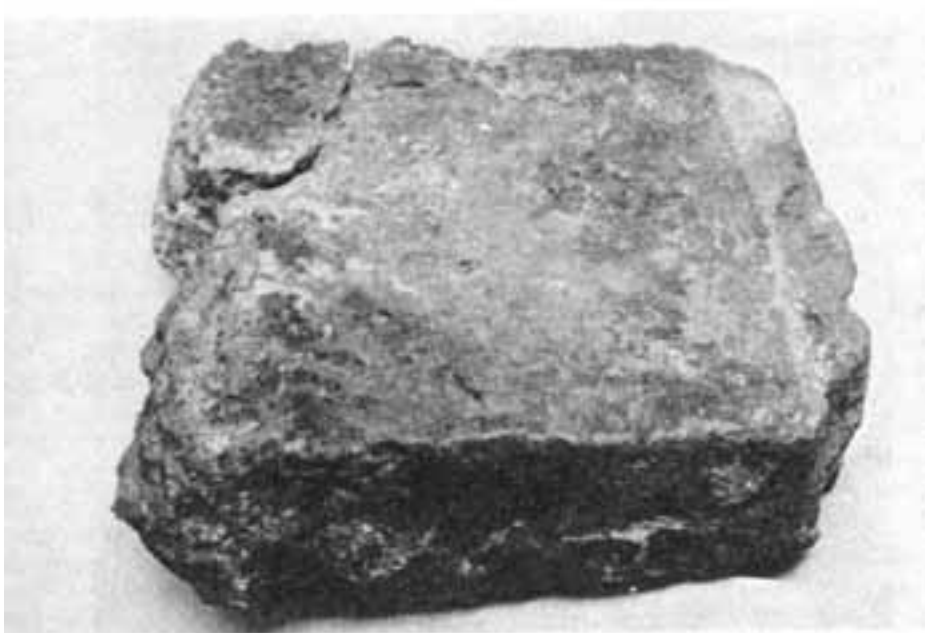
FIGURA 9.3 Bloco de vitrificação mostrando a superfície superior plana, as paredes laterais e uma parte do cadinho ainda aderente ao lado direito.
