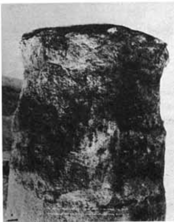
FIGURA 9.3 Bloco de vitrificação mostrando a superfície superior plana, as paredes laterais e uma parte do cadinho ainda aderente ao lado direito.
