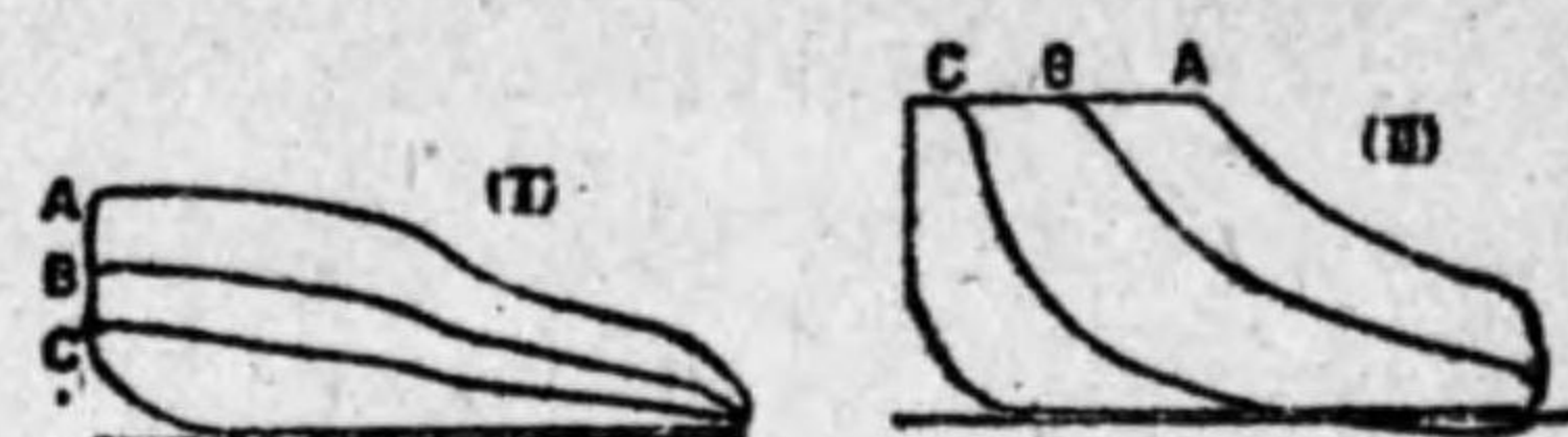
第85圖 调速機の働いた時に出来る指示線圖
