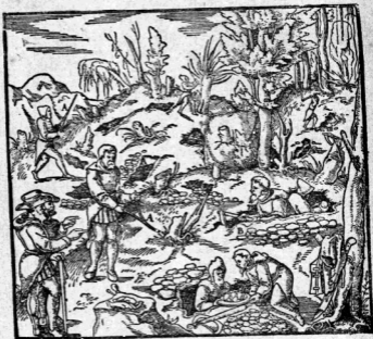
圖四十三——礦工的初步工作。圖中兩人執着探礦棒（A），別的礦工都在開地。在左邊的兩人顯然地是在討論工作的計劃。
