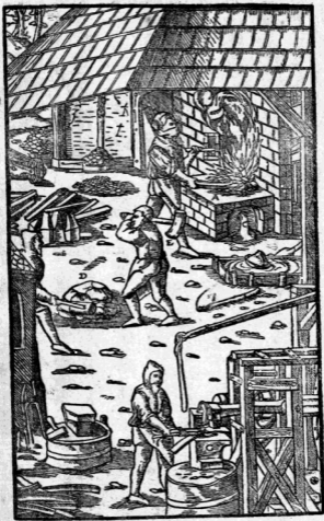
圖十三 阿基柯拉的冶金圖，A. 熔爐；B. 鐵礦石；C. 鐵渣出口處；D. 鐵塊；E. 木輪、F. 鐵輪；G. 鐵粘。站在爐旁的工人面上有面具蒙着。
