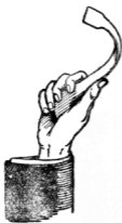
圖二十一 一條含有單個晶體的鋁片可以很容易地彎曲起來。
