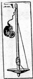
圖二十二 錠子圖。左邊的一束線球，就是備紡的羊毛。錠子當動作的時候是和附在線球上的一條中線成的紗線互相聯絡的，所以一經轉動紗線就捲在錠子上面。
