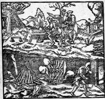
圖五十五——更透地用水和火來分裂岩石。圖中上面的礦工正在做一束一束的柴把，下面的礦工則正將火燃着而後趕快地離開。
