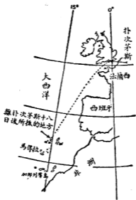
圖八 圖中箭形表明哈禮孫所乘的船的實際方位，虛線表明船長所計算的方位。
