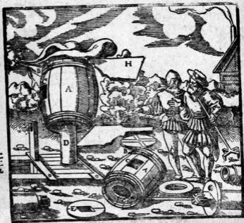
圖五十三——阿基柯拉書中所示的通風器。圖中自左邊吹來的風我們可以見到。
