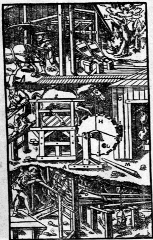
圖五十四——各種鋸風入礦的方法
