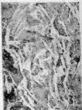
(乙)這塊鋼含有很高成分的碳，所以那嵌在淨鐵碳化鐵中間的碳化鐵晶體已經可以看得出來。
