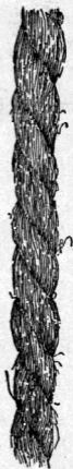
圖三十三 單紗纖維的捻回。和兩根單紗併合起來的捻度的中間是維持着這樣的一個關係，就是使纖維和後者的軸線處於互相平行的地位。
