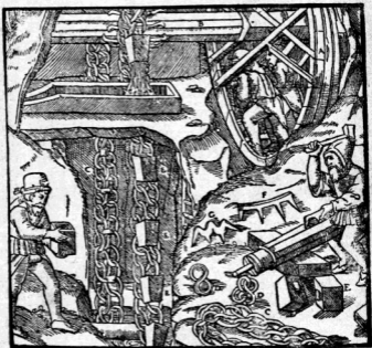
圖四十四——用踏車發動的鍊條戽斗排水圖 圖中一個人正在端着新的戽斗，一個人正在將夾鉗（如 F 及 G）嵌入一個推筒（如 B）裏。
