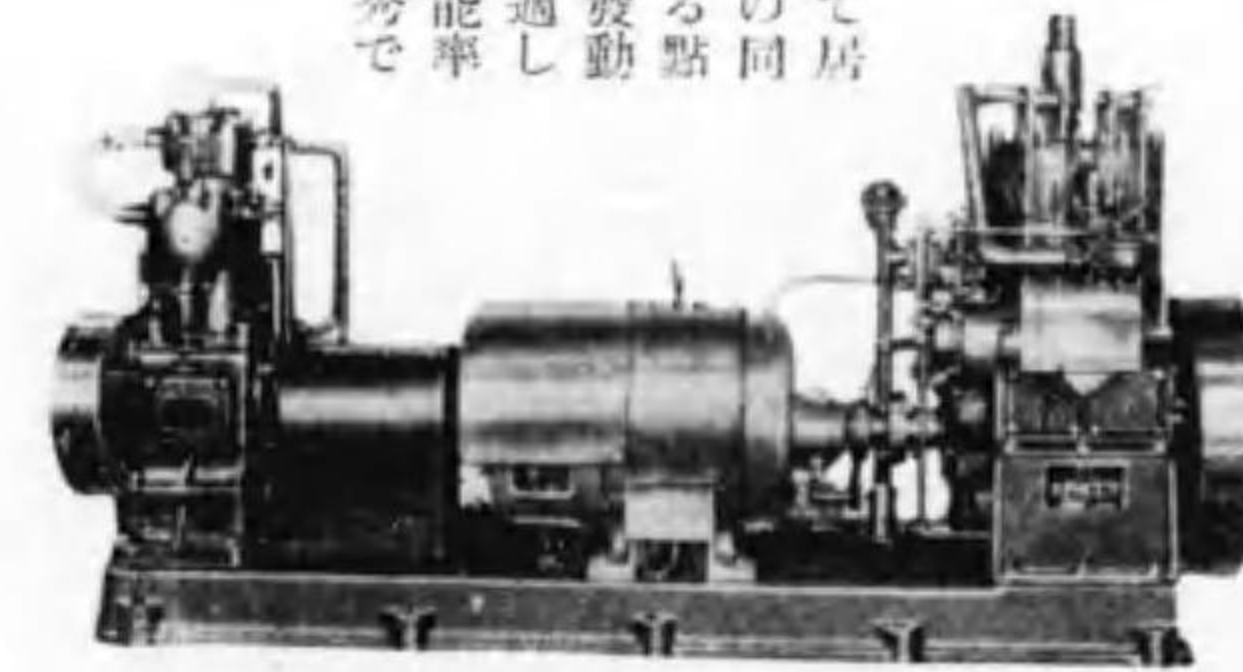
ドイツエンジン補助機 馬力十發直結五キワトロ直流發電機 及二十五立方空氣壓搾機
