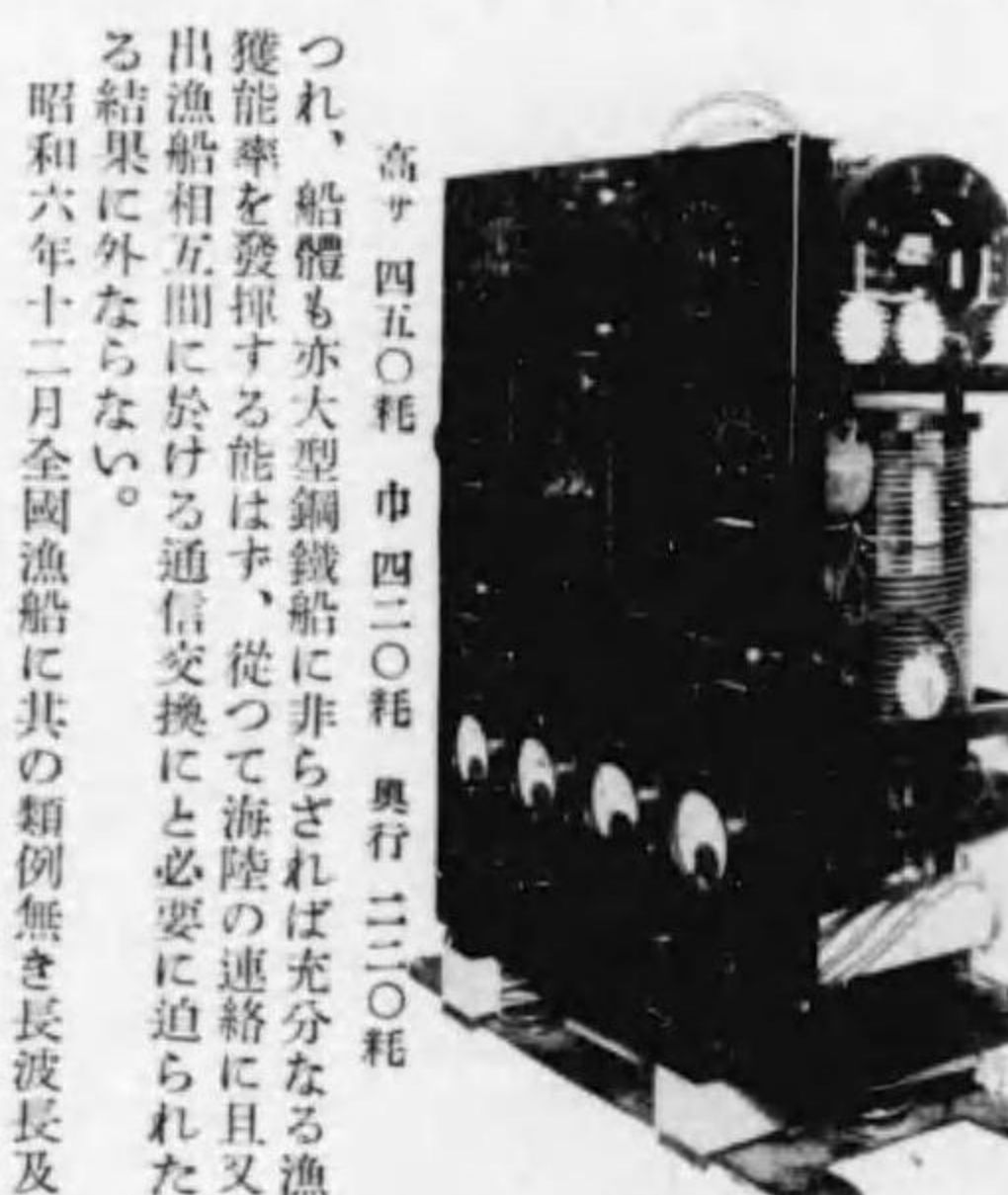
第八號東洋型水昌御製眞空管式長短波兩用無線電信電話送信機
