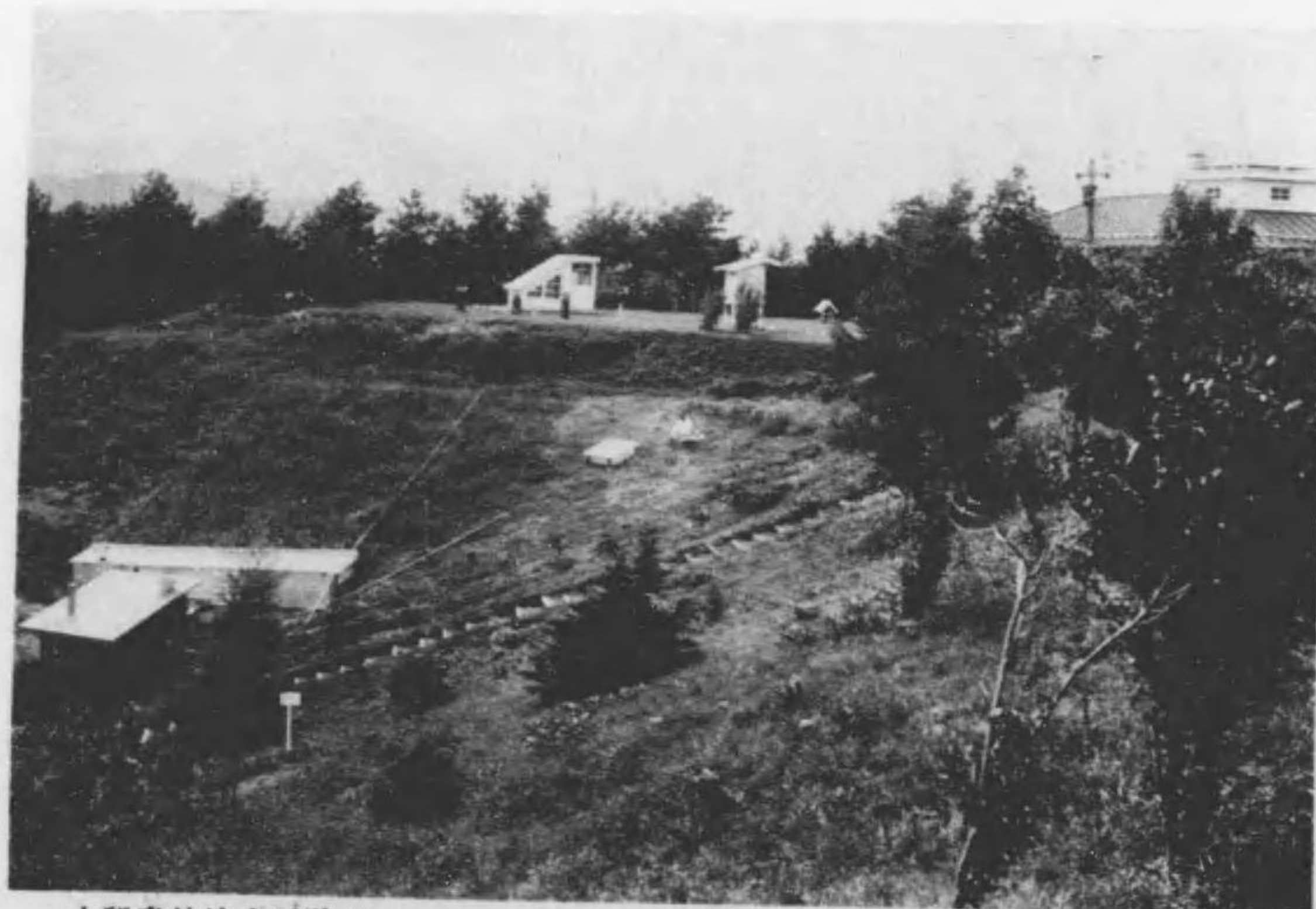
木祖森林治水試験地 (長野縣西筑摩郡木祖村) 氣象觀測露場及地表流下雨量測定設備
