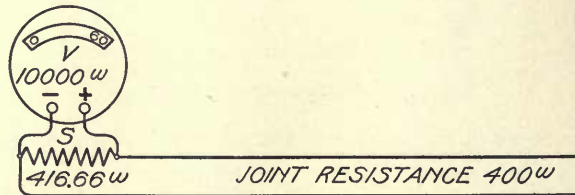
Fig. 659. Shunted Voltmeter
