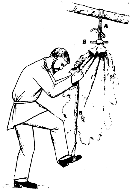
Рис. 4. Розминання овчини ключем. А. Штричка. Б. Цурка. В. Ключ.
