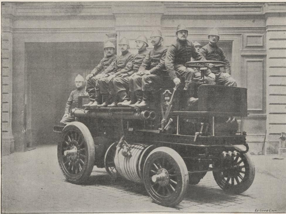
Fig. 2. — POMPE AUTOMOBILE A VAPEUR DES SAPEURS-POMPIERS DE LA VILLE DE PARIS : Vue de l'avant.
