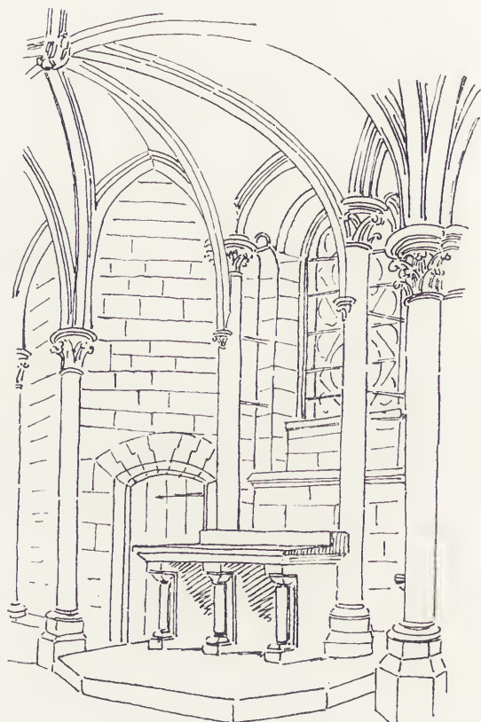
AUTEL SAINTE-MARTHE, CATHÉDRALE DE CONSTANCE. Longueur de la table : 1 m 85 ; largeur : 0 m 95. Hauteur de l'autel : 1 m 04 ; chanfrein : 0 m 10. Largeur du champ qui couronne les piliers : 0 m 17. Largeur de ces piliers sur la face : 0 m 09.
