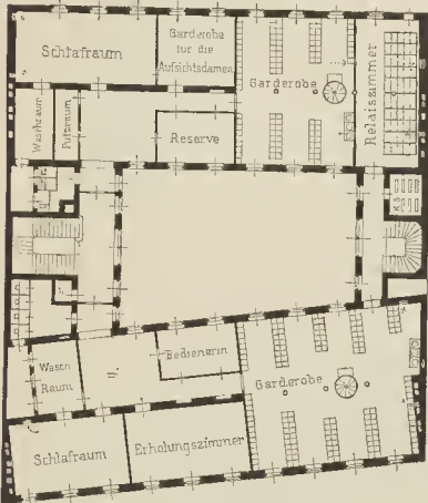
Grundriss der Telephoncentrale, Architekt Eugen Fassbender.
