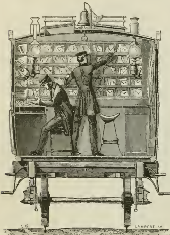
Nr. 366. Das Innere eines Eisenbahn-Postwagens.
