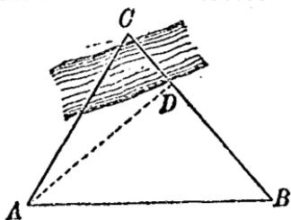
測定其長度；次在  $A$  點測  $\angle BAC$  的度數，在  $B$  點測  $\angle ABC$  的度數，那末，在  $\triangle ABC$  內，
