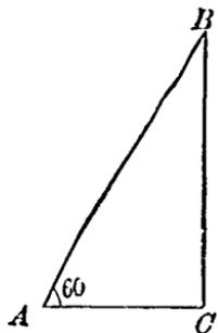
§28. 距離的測量 假定觀測者的位置是  $A$ ，測點是  $B$ 。要測  $AB$  間的距離，可過  $A$  引一水平線或鉛垂線，過  $B$  引一鉛垂線或一水平線，造成直角三角形。測得一銳角和一腰的長，就可求得  $AB$ 。
