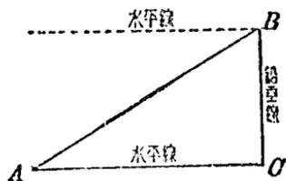
在測量距離或高的時候,須先定一適當直線(這直線的長是可以直接測得的)。用這直線做一邊,造成一三角形,應用三角形的解法就可以計算所求的距離或高。這樣聯得的直線,叫做基線。
