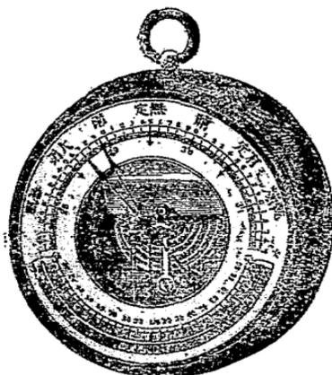
緣刻度,表示氣壓強度;如氣壓低,可知空中已飽和水汽而將雨,反是將晴也。且氣壓必由高處向低處,又得藉以預測風向;氣壓必距地面愈高而愈小,又得藉以測量高山。
