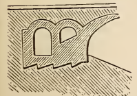
Fig. 22. Gezähnte, und Fig. 23. Getreppte Gründungsbasis von Widerlagspfählern.
