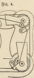
Fig. 2-4. Charrières künstlicher Vorderarm. Fig. 5 u. 6. Bly's künstliches Bein.
