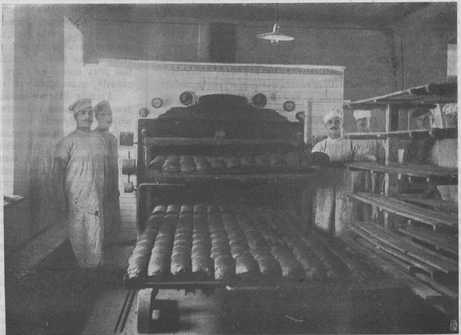
Наружный вид печи съ выдвинутыми подами и со стоящей съ боку передвижной полкой. (Къ ст. «Солдатскій хлѣбъ»).
