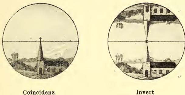
Fig. 11 und 12 Einstellen des Entfernungsmessers nach dem Messen.
