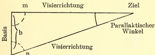
Fig. 1 Prinzip der Basis-Entfernungsmesser.
