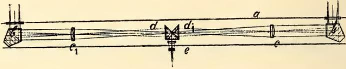
Fig. 8 Strahlengang im Entfernungsmesser.
