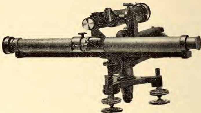
Fig. 2 Entfernungsmesser System Bode.
