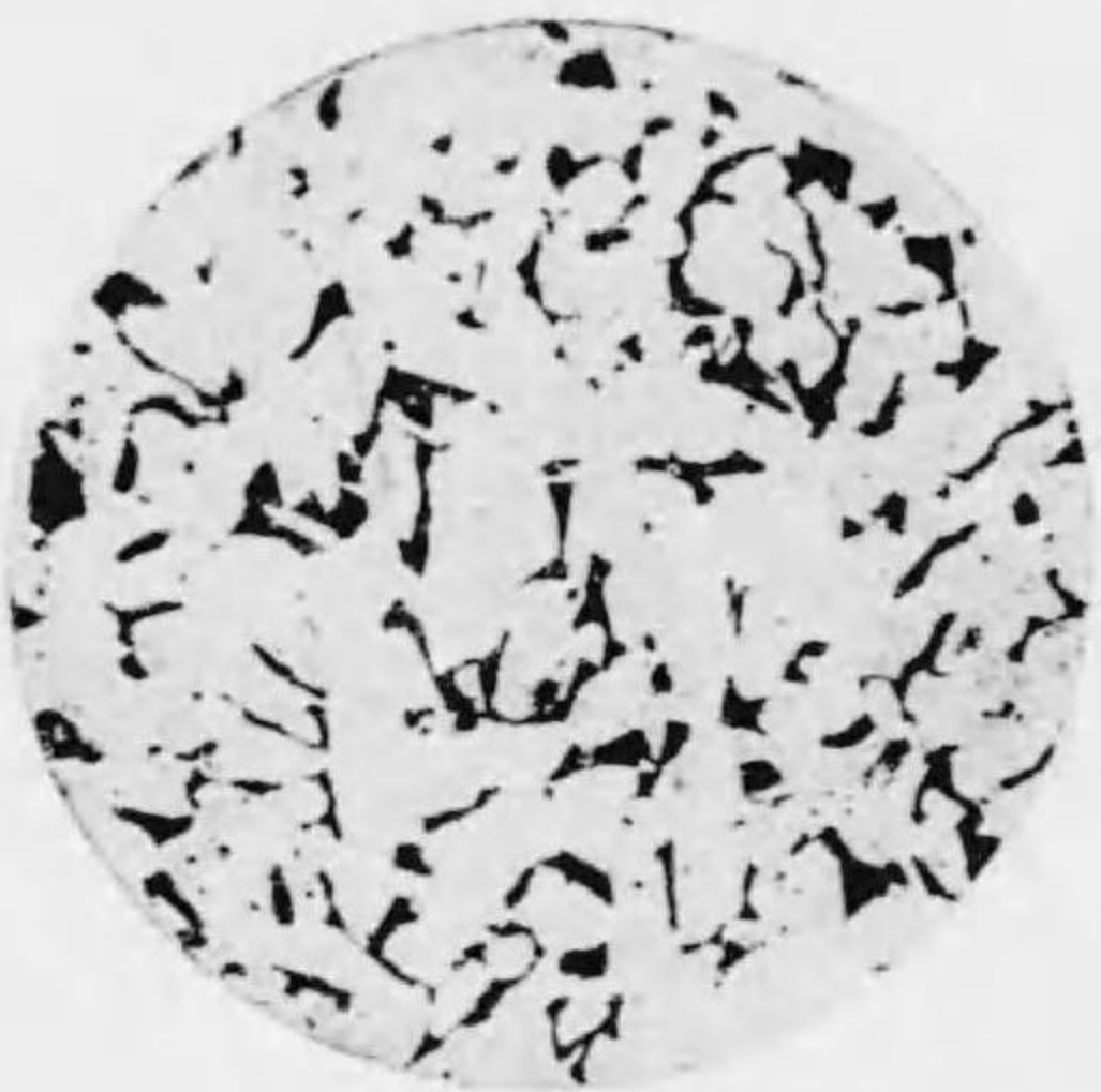
第九十九圖 炭素〇・一八五%を有する軟鋼の組織百七十倍
