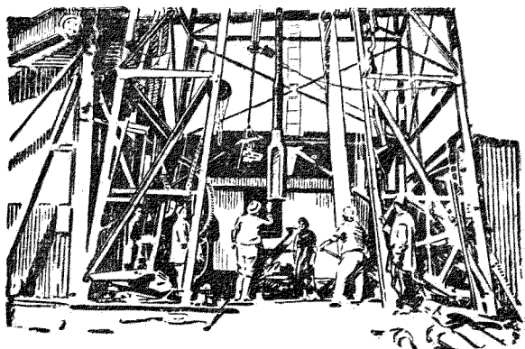
第142圖 穿石油井用的穿孔器具。圖正中立着一人正檢驗着重鋼鑽，用鐵練舉至極高度後任其落下。
