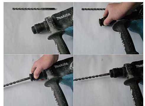
SDS-Bohrer einspannen
