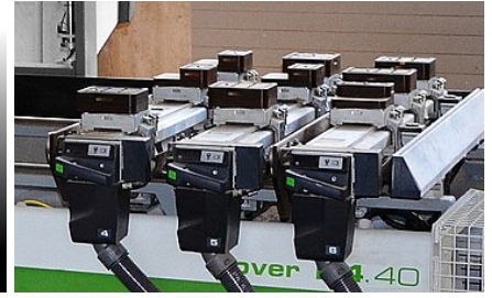
Tisch aus 3 Trägern für Vakuumsauger
