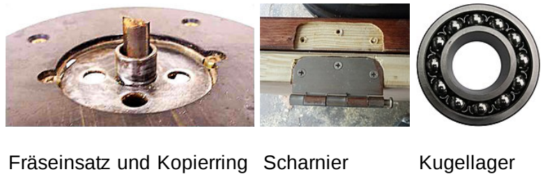
Fräseinsätze, mit und ohne Anlaufring (Kugellager)
