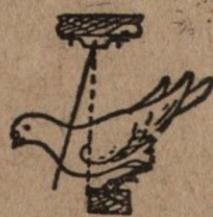
活瓣門。如十四圖，用長一尺六寸六分十號鐵綫折成——形，使二脚各長七寸五分，闊一寸六分，吊在進口的上框，下面較下框稍長，使扣住下框。這樣子因為活瓣是吊着的，可以推動。但是只許朝裏推動，却不能朝外推動。這個便是活瓣門。
