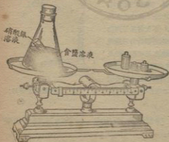
第 13 圖 封閉器中之化學變化，總重量不變。
