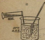
第 221 圖 牛乳中加醋酸使 乾酪素起膠凝
