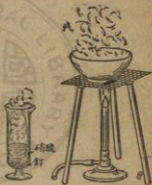
第10圖 鐵釘溶於溶液中而蒸發至乾。
