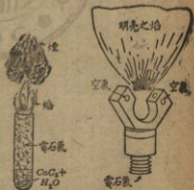
第 259 圖 於試管中及於規定燈頭中燃電石氣
