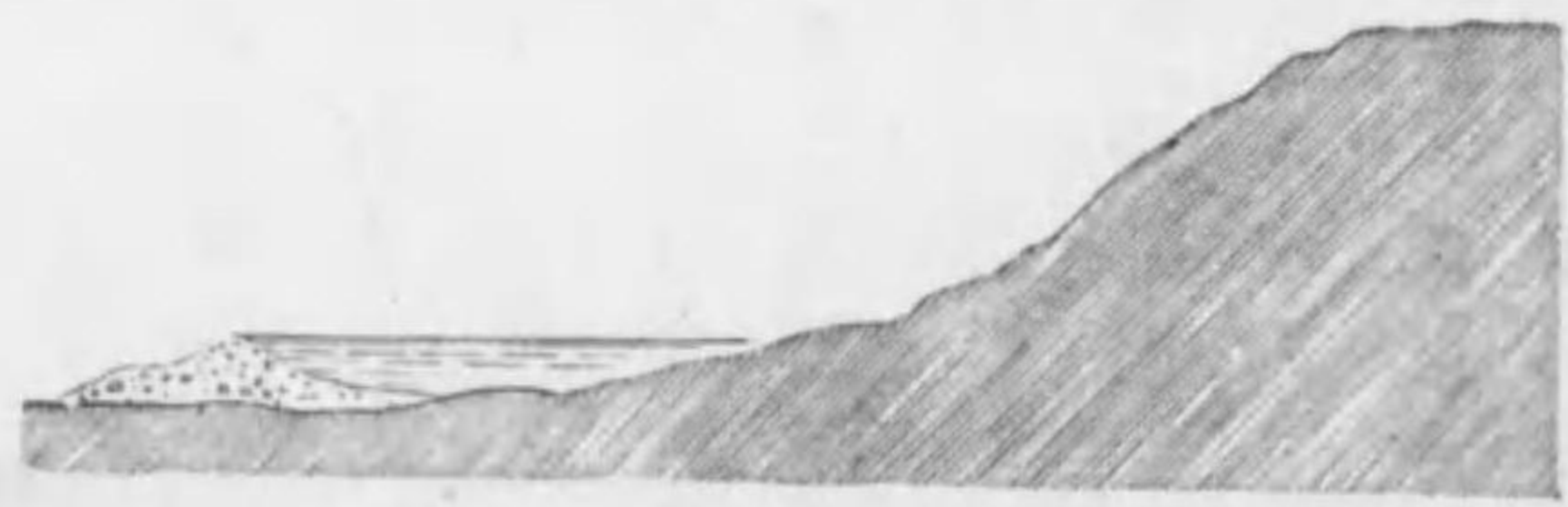
第五十七圖 土砂ノ 屏障ヲ 以テ堤 防ヲナ シタル 湖水ノ 横截圖
