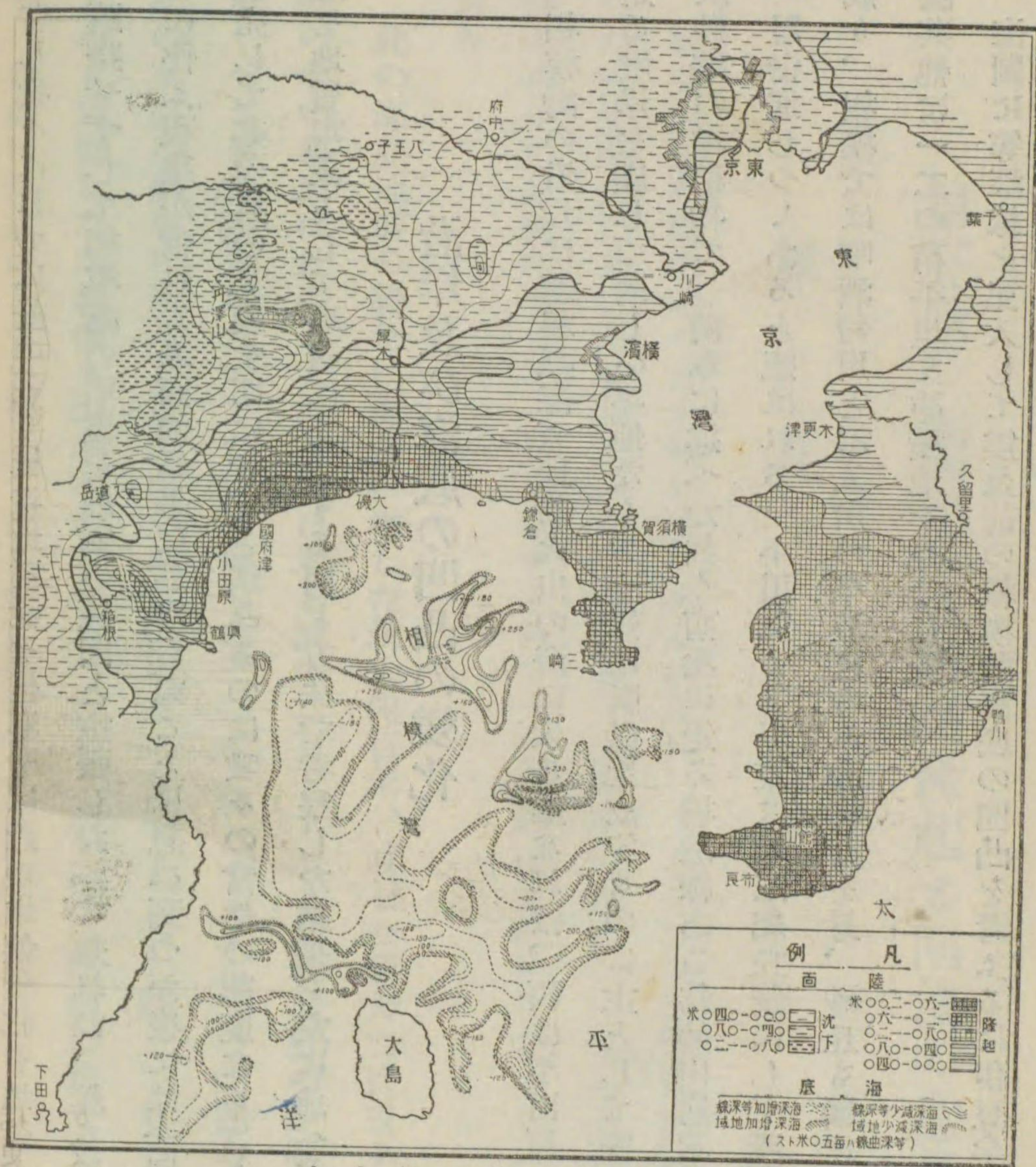
第三十一圖 關東地震に因る陸海凹凸の變化 (陸地測量部及水路部原圖に據る)
