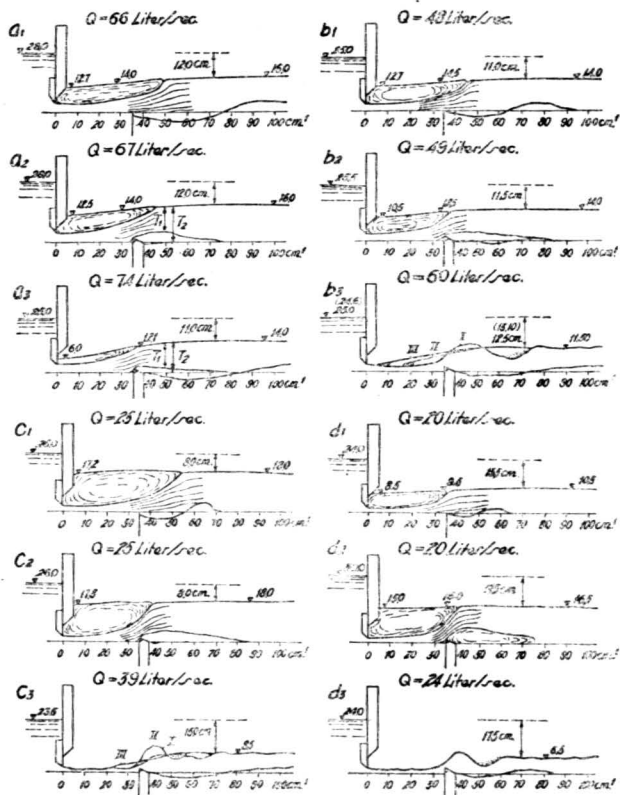
附圖一 水平護坦水閘之沖刷試驗一有齒形堰與無齒形堰 (參考 Dr. G. Luascher 著雷氏齒形堰試驗原文載 Schweizerische Wasserwirtschaft , 1927, No. 7, P. 95.)
